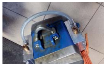
FOT. 5. Wciągarka z wymiennikami wodnymi
